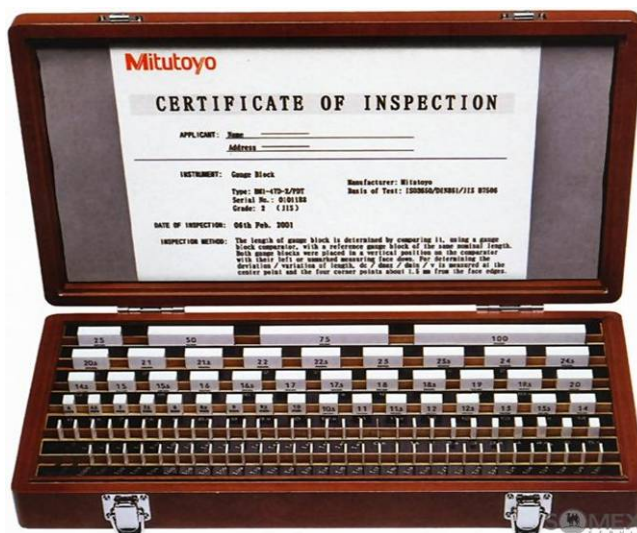
Obr. 8. Koncové měrky z keramiky – sada 8 kusů
