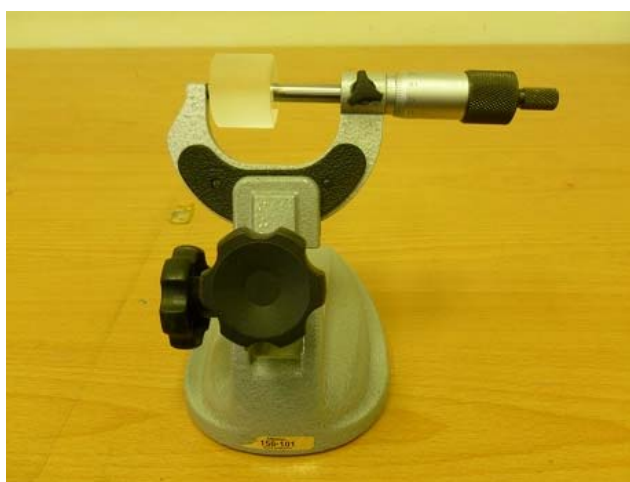
Obr. 12. Měření rovnoběžnosti dotyků
