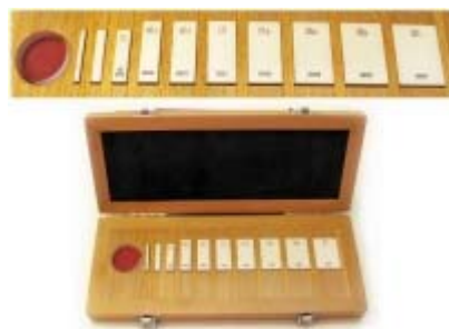
Obr. 7. Sada měrek na kontrolu mikrometru
