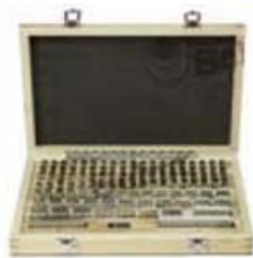
Obr. 9. Základní koncové měrky ocelové 88 ks
